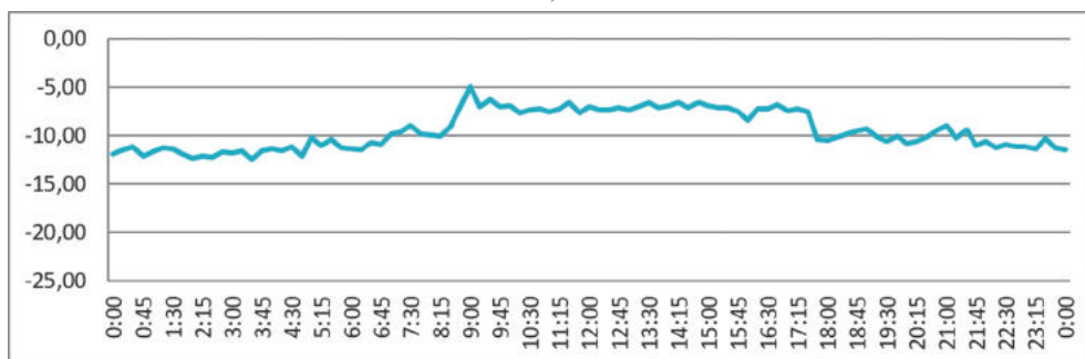
Рис. 11. Пример суточных графиков ЦПС «Петровск-Забайкальская»: б – напряжения 110 кВ; в – напряжения 35 кВ; г – мощности магнитно-вентильного управляемого реактора 25 МВ·Ар, 38,5 кВ
